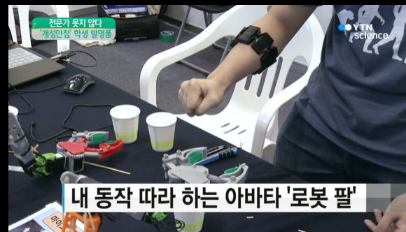
< 근전도 제스처 센서를 사용해서 로봇 팔 제어 > 하드웨어: Myo 근전도 + 6축 가속도 센서, DRS-0101 서보모터, 3D 프린트 관절 소프트웨어: C#, Myo API
